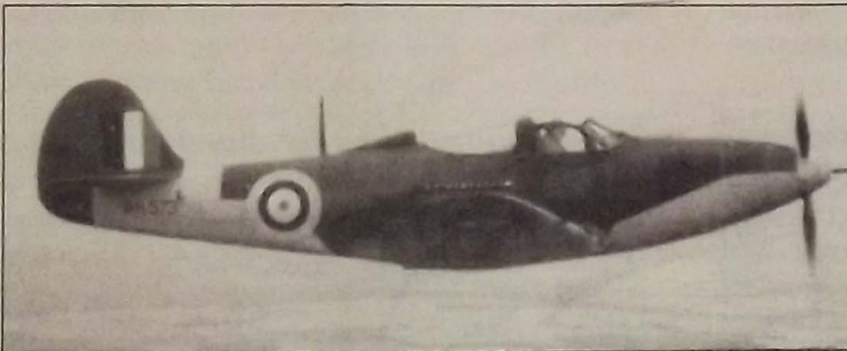
"Аэрокобра" на испытаниях в Великобритании: англичане испытали шок, когда поняли, что скорость нового истребителя оказалась на 60-70 км/ч ниже заявленной фирмой! Но реклама уже сделала свое дело...
