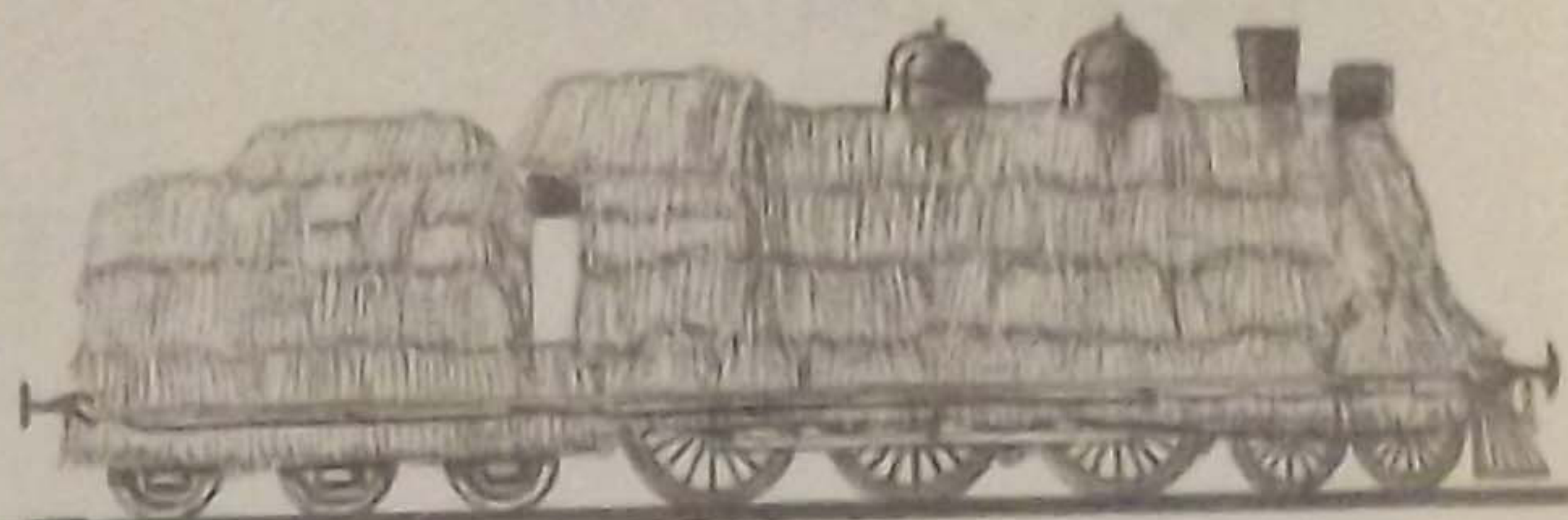
Паровоз, оборудованный защитой из канатов
